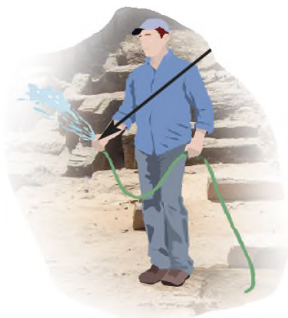
BAGNATURE SUPERFICIE DI SCAVO
